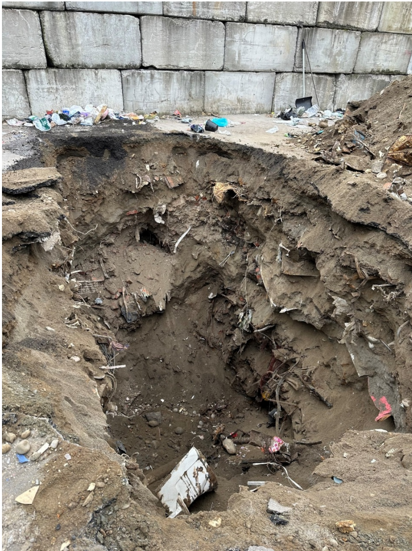
Foto 3: Prøvegrop P8 med gravedybde ned til 4,5 meter
